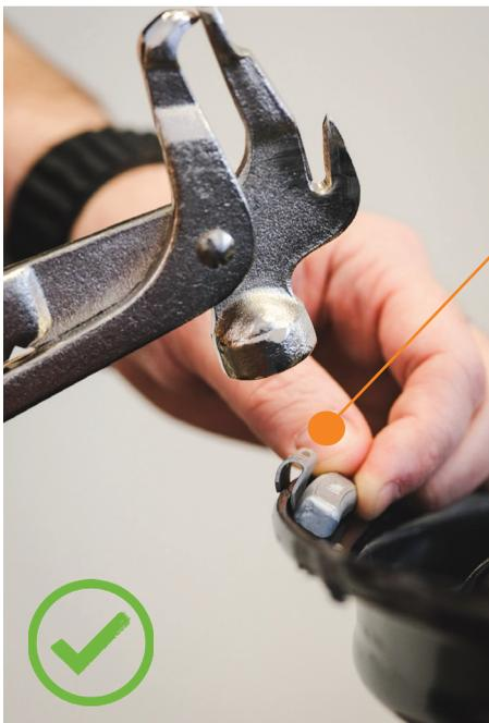
Toujours s'assurer d'aligner parallèlement la pesée sur la roue pour assurer une installation optimale.
